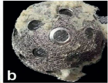
Abbildung 2 a Schematische Darstellung des Verbundes von Knochen zum Titandrahtgeflecht und der Titanium-Kernschale; b vollhemisphärisch intakte Beschichtung eines Explantates
