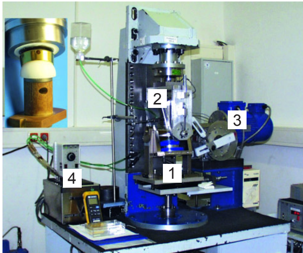
Abbildung 3 Prüfvorrichtung Verschleißuntersuchung. 1: Gleittisch (axiale Krafteinleitung, Flexionsbewegung und Glenoidaufnahme), 2: Schwinge (Schulterkopfaufnahme und Realisierung der Abduktionsbewegung), 3: Elektro-mechanischer Antrieb der Schwinge, 4: Thermostat.
