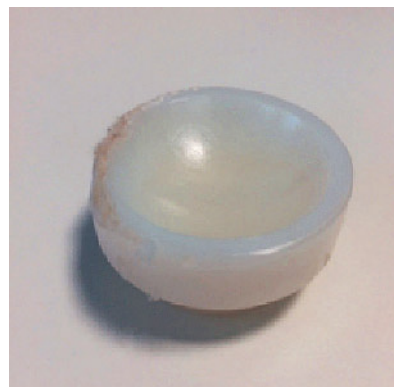
Abbildung 2a Explantiertes humerales Inlay einer inversen Schulterprothese mit deutlichem Defekt des Polyethylen bei 9 Uhr aufgrund eines Notching.
