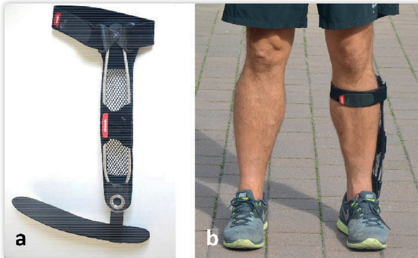
Abbildung 7a-b Neuartige Fuß-Sprunggelenk-Orthese zur Korrektur der Beinachse (Agillium freestep Otto Bock, Duderstadt). Diese Orthese besteht aus einem Fuß- und Unterschenkelteil, welche über ein Gelenk miteinander verbunden sind. a) Das Gelenk ist ausschließlich in der Sagittalebene frei beweglich. b) In der Frontalebene werden OSG und USG rigide überbrückt.
