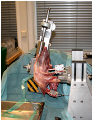
Abbildung 3 Kniegelenkinemator mit eingespanntem Kniegelenkpräparat. Zentral im Bild ist das eingespannte Präparat erkennbar mit der unten im Bild befestigten Zugklemme auf der Sehne des M. quadriceps. Nach vorne unten erkennt man die abgeleitete Tekscan-Sensorfolie.
