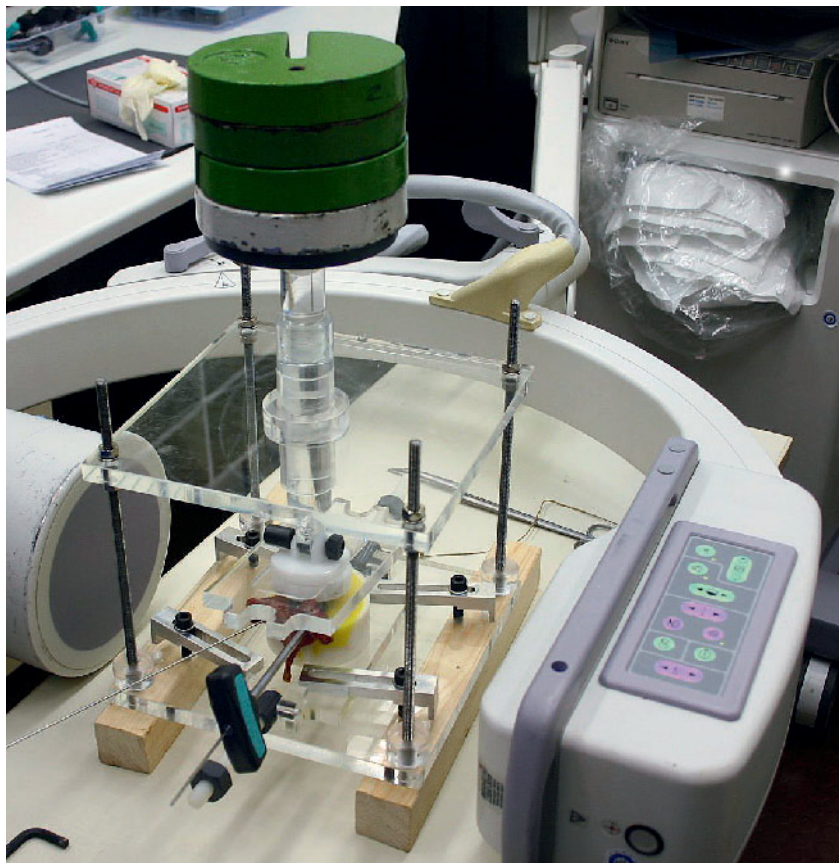
Abbildung 3 Die operativen Verfahren wurden in einem dafür hergestellten Belastungsrahmen durchgeführt, der es zuließ, dass während der gesamten Prozedur bis zum Aushärten des Zements eine Kraft von 100 N auf den Wirbelkörper einwirkte.
