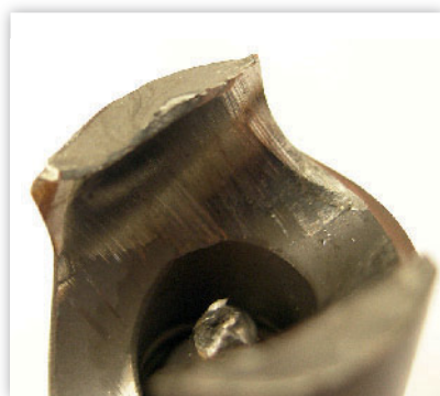
Abbildung 2 Beschädigung eines cephalomedullären Nagels durch inkorrekte Bohrung des Lochs für die Schenkelhalschraube
